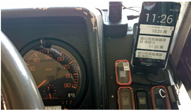
図-5 運転席横に取り付けたスマートフォンによるバスロケーションシステム
