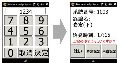
図 6 系統番号方式による端末と運行情報の対応付け
